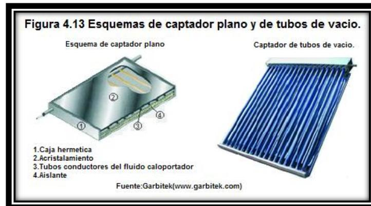
Los sistemas de captador plano disponen, básicamente, de una placa absorbente, por ejemplo, cromo negro, un aislamiento térmico, un fluido portador de calor, un sistema de conducción del fluido y un tanque de almacenamiento térmico convenientemente aislado.
